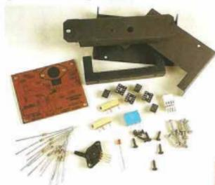
Figura 7.5a Componentes necesarios para el ensamble del medidor de presión
