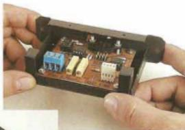
Figura 7.5c Aspecto de la tarjeta en el chasis del medidor
