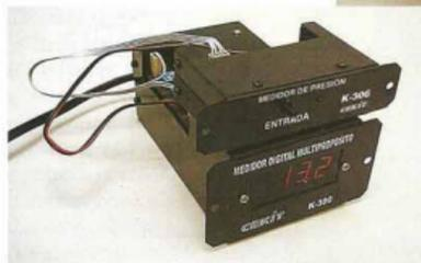
Figura 7.5d Conexión del medidor de presión al medidor digital multipropósito, para visualizar la lectura
