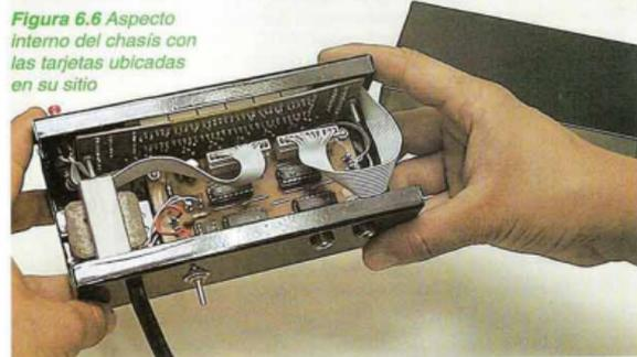
Figura 6.6 Aspecto interno del chasis con las tarjetas ubicadas en su sitio
