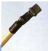
Figura 2.5 Aspecto del sensor de temperatura LM35 el cual ha sido forrado con cinta termoconducible, quedando listo para instalarlo en el sitio de medición
