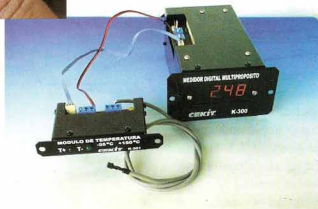
Figura 2.7 El módulo de temperatura puede adaptarse al medidor digital multipropósito, K-300
