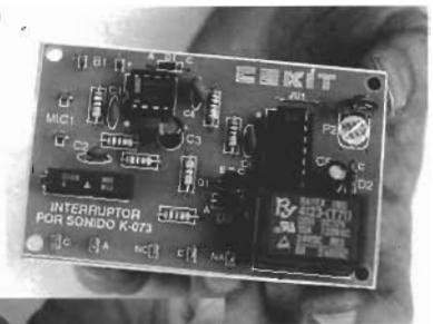
Figura 22.4 El ensamble de la tarjeta es muy sencillo, se debe poner especial atención en el momento de hacer la soldadura para no causar cortos entre puntos adyacentes, además, en los sitios donde se conectan cables se deben poner espaldines para facilitar la posterior soldadura de los mismos.
