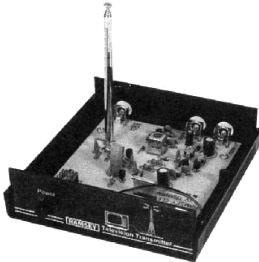
Vista del equipo terminado y montado en su gabinete
